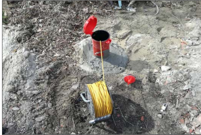
pozzetto e misure freatiche
