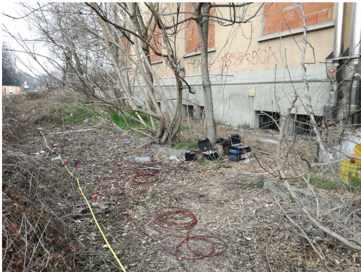
Fig. 10 – Prospezione sismica MASW , foto realizzazione indagine
