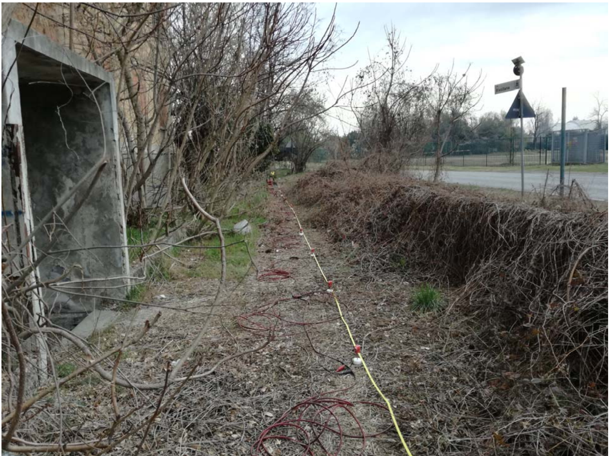
Fig. 9 – Prospezione sismica MASW , foto realizzazione indagine
