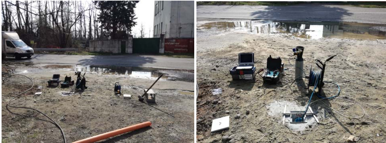
Fig. 3 – foto esecuzione indagine DH, geofono doppio combinato e sismografo
